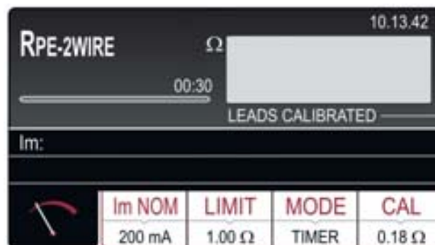
Fig. 4: Page-écran de base de la fonction RPE-2WIRE
