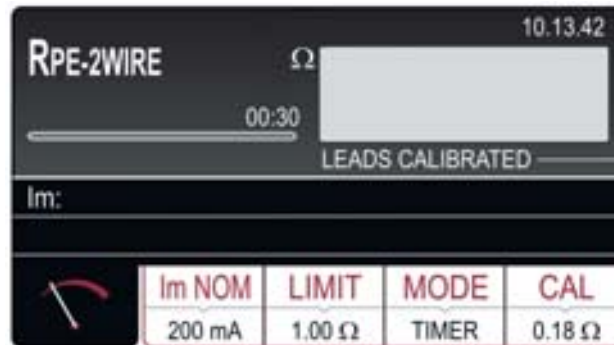
Fig. 25: Écran initial fonction RPE-2WIRE
