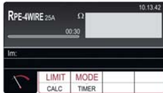
Fig. 29: Écran initial fonction RPE-4WIRE
