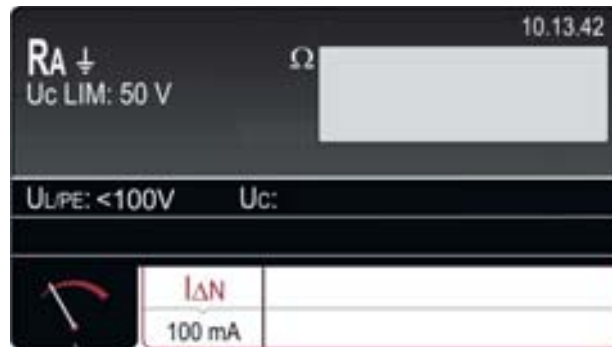
Fig. 51: Écran initial fonction RA↓
