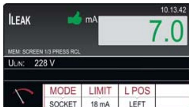
Fig. 87: Menu RECALL – Rappeler le résultat
